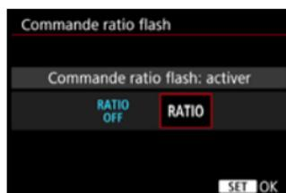
Avec un flash macro (MR-14EX II, etc.) compatible avec les réglages de fonction du flash, vous pouvez régler le ratio de flash entre les tubes flash ou les têtes de flash A et B, ou encore utiliser le flash sans fil avec les flashes asservis.
