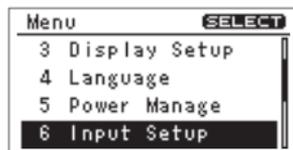
2. Utilisez [ ▶/|| ]/[ ■ ] pour déplacer le curseur vers le paramètre Limiter/AGC, puis utilisez [ ◀◀ ]/[ ▶▶ ] pour sélectionner Limiter ou AGC.
