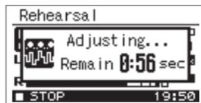
Le niveau d'enregistrement est réglé automatiquement en fonction du volume maximal rencontré durant la période spécifiée par le paramètre Rehearsal Time. En même temps, l'appareil effectue également un test visant à déterminer la sensibilité appropriée pour le micro. Une fois le réglage terminé, le R-05 passe en mode d'attente d'enregistrement. Si le paramètre Rehearsal Time est défini sur MANUAL, appuyez à nouveau sur [REHEARSAL] pour terminer la répétition.
